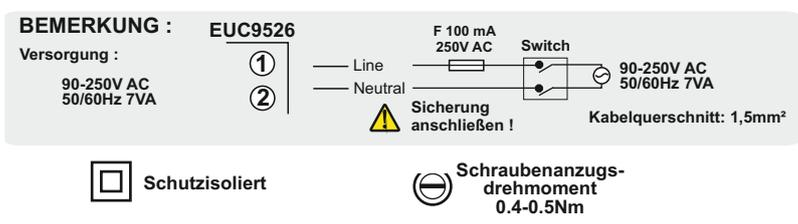
Logikausgang des Gerätes EUC9526 Serie ist zur Elektronik nicht galvanisch isoliert. Bei Verwendung von geerdeten Fühlern dürfen diese nicht mit Logikausgang verbunden werden !
