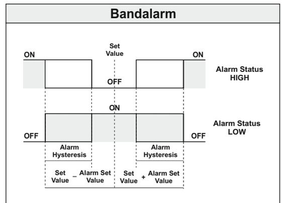
Bandalarm mit Unterdrückung (nach dem Einschalten)
