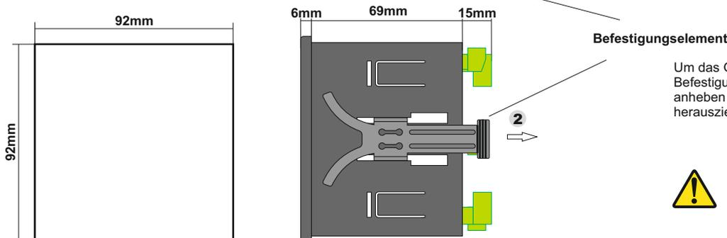
Um das Gerät auszubauen, Befestigungselemente in Richtung **1** anheben und in Richtung **2** herausziehen.
